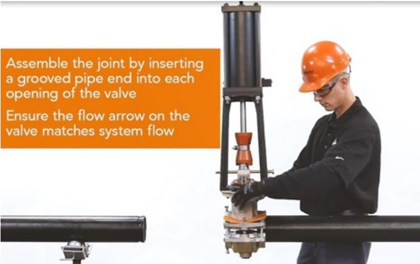
Con solo un dispositivo de elevación, 4 pernos de ajuste y una o un máximo de 2 personas, es posible instalar el KGV
